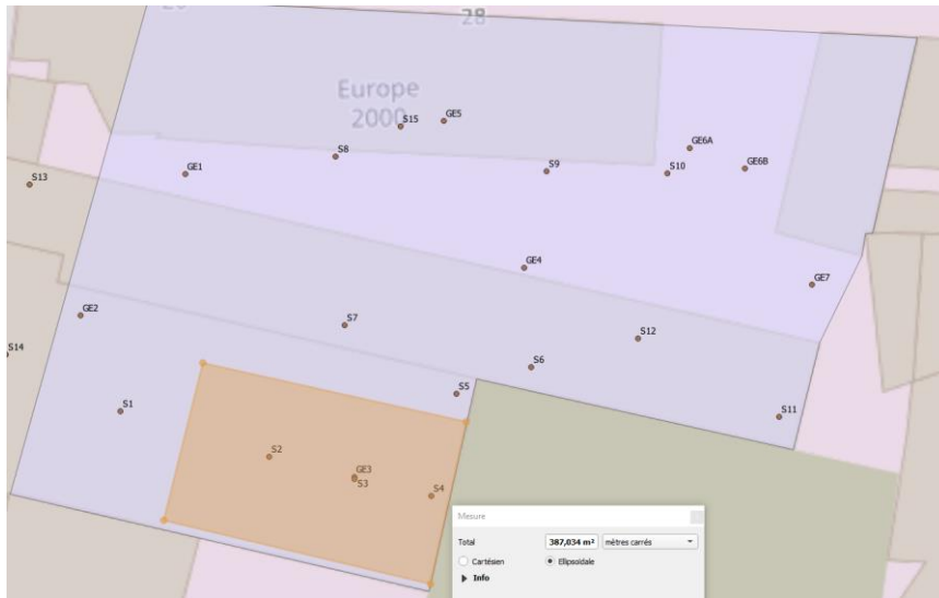
Figure 11 : Impact en COHV au droit des sondages S2, S3, S4 et GE3
